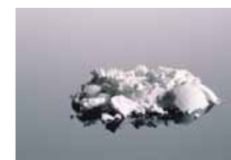
Традиционные стеклоиономерные порошки уплотняются во время хранения и при вынимании ложечкой неравномерно дозируются
